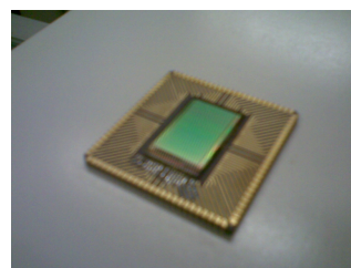
Foto di un Focal Plane Assembly del tipo di quello che verrà posto nello strumento e che sarà sottoposto a test.
